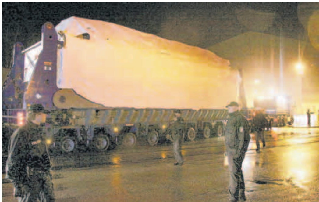
Gegen Mitternacht wird der insgesamt mehr als 600 Tonnen schwere Spezialtransport mit dem ersten von zwei neuen Großtrafos auf das Kraftwerksgelände am Elbufer gefahren. Fotos: Jann
